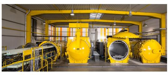
10台热压罐(最大尺寸3.5 x 11 m)
